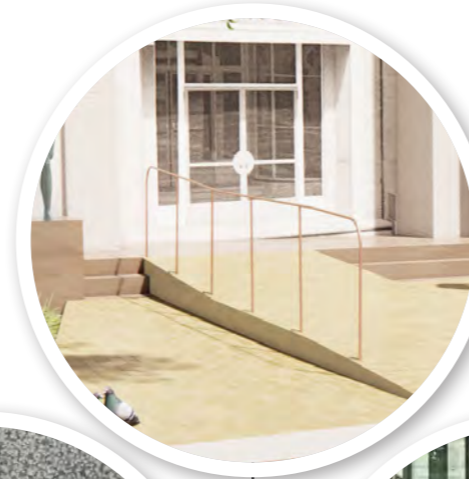
eenzijdig leuning aanbrengen langs hellingbaan, rank rond smeedijzer Ø15mm, kleur naturel staal, verduurzaamd met owatrol coating
