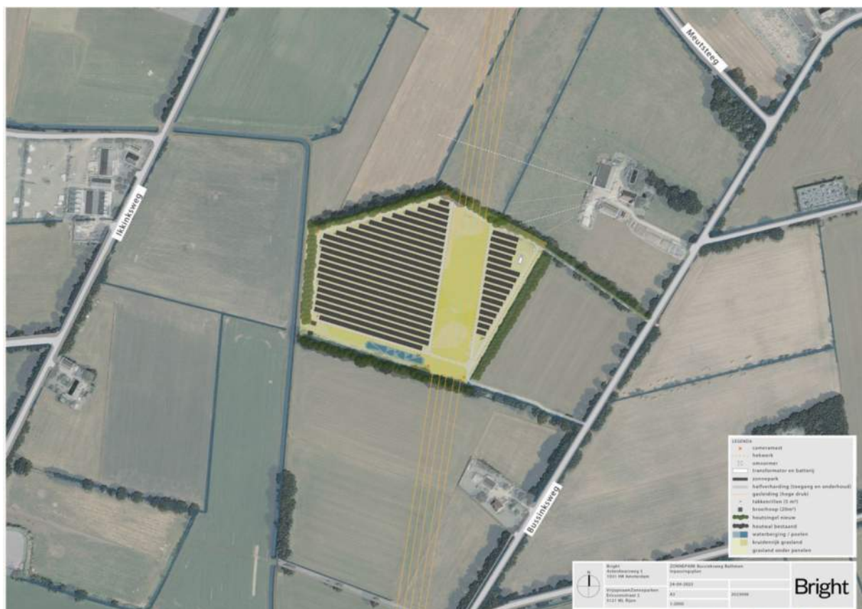
Figuur 12: Inpassingstekening zonnepark met energieopslagsysteem.
